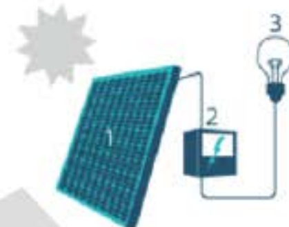
1. Zonnepaneel | 2. Omvormer | 3. Elektrische toestellen
